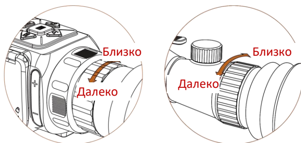
Рис. 3-1. Регулировка кольцом фокусировки
