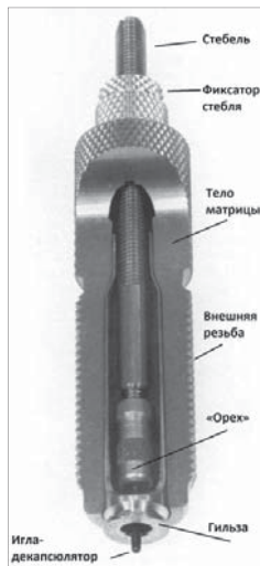
Обжимная матрица пр-ва RCBS в разрезе.
