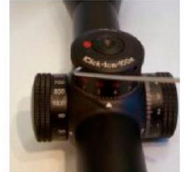
После настройки вертикальных поправок (6), открутите оба винтика на барабане горизонтальных поправок. Получив свободно вращающийся механизм (без слышимых кликов), выровняйте «0» на барабане со стрелкой на корпусе прицела и затяните винты.
