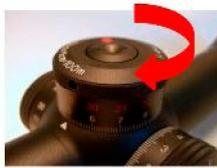
Если точка попадания ниже точки прицеливания, то поворачивайте барабан вертикальных поправок (6) по часовой стрелке (маркировка H-> на крышке)
