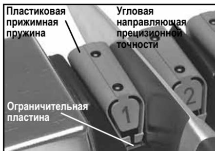
Рисунок 3. Лезвие ножа вставляется между угловой направляющей и прижимной пружиной пока не будет слегка касаться ограничительной пластины.
