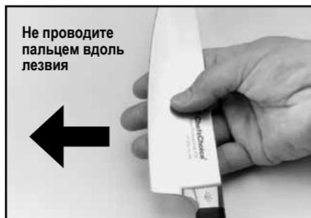
Рисунок 7. Заусенец можно определить, если провести пальцем поперек лезвия и от себя. Осторожно! См. текст.
