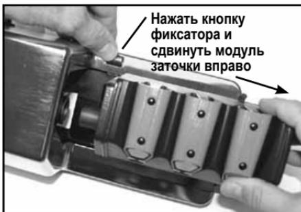
Рисунок 16. Модуль Заточки легко снимается при необходимости очистки. Нажмите кнопку фиксатора и сместите Модуль Заточки вправо.
