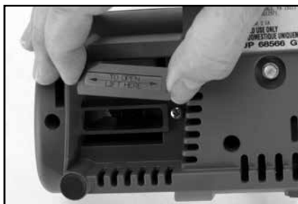
Малюнок 17. Зняття кришки знизу корпусу, щоб очистити прилад від металевого пилу (див. розділ Повсякденне обслуговування).
