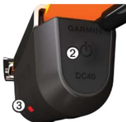
Когда устройство DC 40 будет включено и начнет установку связи со спутниками, красный индикатор ③ мигнет один раз.
