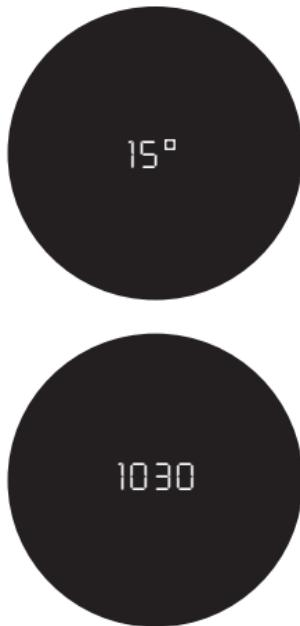
Para el cálculo exacto del punto de impacto (ver a este respecto la siguiente sección), el Leica Rangemaster 2000-B determina además durante la medición de la distancia tres informaciones adicionales importantes: la inclinación del aparato, la temperatura y la presión de aire. Los valores correspondientes se pueden visualizar en cualquier momento.
