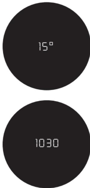
Für die genaue Berechnung der Treppunktlage (siehe dazu den folgenden Abschnitt) ermittelt der Leica Rangemaster 2000-B während der Entfernungsmessung zusätzlich drei wichtige Zusatzinformationen: die Neigung des Geräts, die Temperatur und den Luftdruck. Die jeweiligen Werte können Sie sich jederzeit anzeigen lassen.
