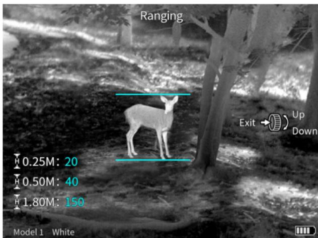
2. Выровняйте нижнюю горизонтальную линию по нижней части целевого изображения, поверните ручку вверх и вниз, чтобы изменить ширину между верхней и нижней горизонтальными линиями, пока верхняя горизонтальная линия не будет выровнена по верхней части целевого изображения, затем расстояние может быть автоматически рассчитано и отображено.
