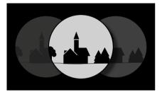
Индивидуальная настройка расстояния между глазами достигается сгибом по шарнирной оси. При правильной настройке расстояния между зрачками поля зрения справа и слева сливаются в единое изображение круглой формы.
