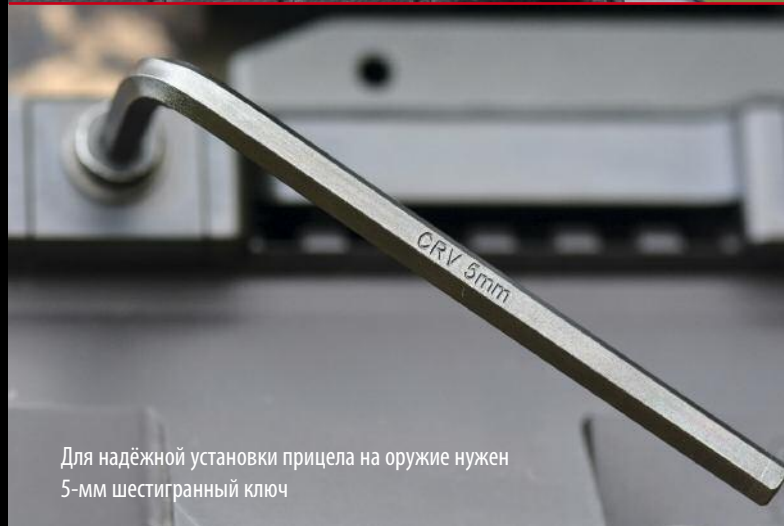
Нижняя часть кронштейна прицела, предназначенного для установки на планку «вивер/пикатинни»
