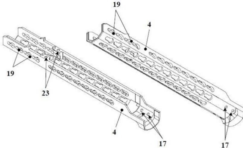
Для завершения установки шасси –нижнее полу цевье (4) прикрепляется к ствольной муфте (6) и верхнее планке (5) винтами.
