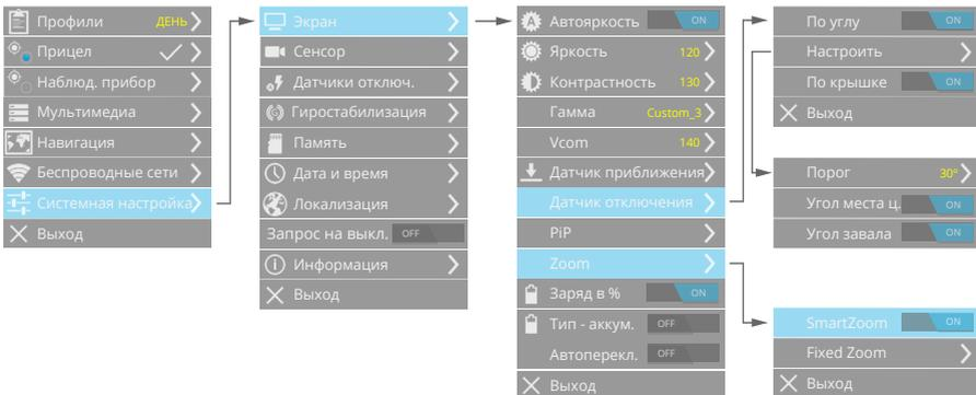
Устройство позволяет производить отключение экрана прибора по датчикам угла и при закрытии крышки. Для датчика угла настраивается по каким углам производить отключение - угол места цели и угол завала; а также угол отключения.
