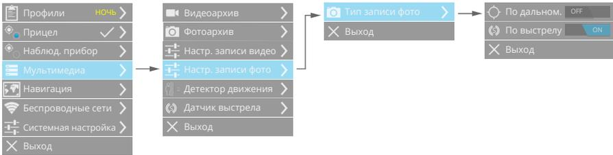
Устройство позволяет производить запись фото. Запись фото производится вручную 2х секундным нажатием кнопки Вправо или в автоматическом режиме - при измерении дистанции, по выстрелу.
