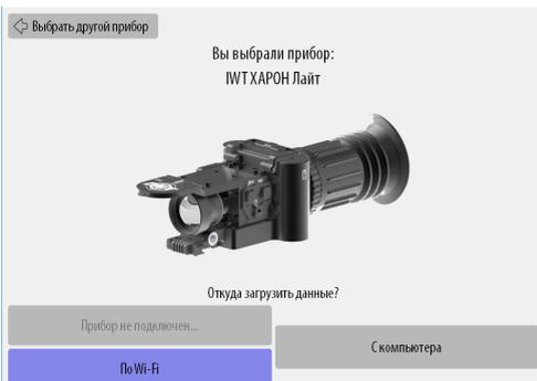
Также программа IWTHunter позволяет произвести подключение через карту памяти microSD Вашего прибора (только для приборов, имеющих разъем для карты памяти microSD). Для этого - выньте карту памяти из прибора и с помощью переходника microSD-SD или microSD-USB подключите карту памяти к компьютеру. Компьютер определит карту памяти как съемный диск IWT. В программе IWTHunter выберите «С компьютера»:
