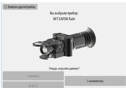
Вы можете подключить прибор либо по USB, либо по Wi-Fi. Для подключения по USB - включите прибор и подключите его по USB с помощью прилагаемого кабеля (при этом для приборов с разъемом microSD должна быть установлена карта памяти). После загрузки прибора программа автоматически определит наличие подключенного прибора, в результате кнопка подключения станет активной:
