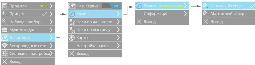
Несмотря на то, что встроенное программное обеспечение запускает автоматическую калибровку датчиков (акселерометра, гироскопа и магнитометра) в фоновом режиме, необходимо произвести некоторые предварительные шаги для более точной работы.
