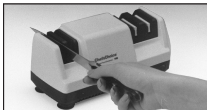
Етап 1— Тричі (3) або більше* повільно проведіть через кожен паз, (лівий і правий пази ПОПЕРЕДНЬОЇ ЗАТОЧКИ ). Чергуйте пази щоразу.
