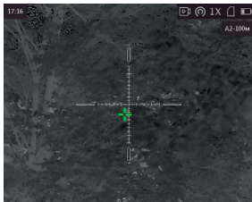
Рис. 5-1. Отслеживание горячих точек
